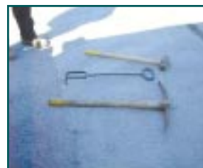
OUTILS DE LEVAGE : MASSE, CROCHET DOUBLE ET PIC DOUBLE.
